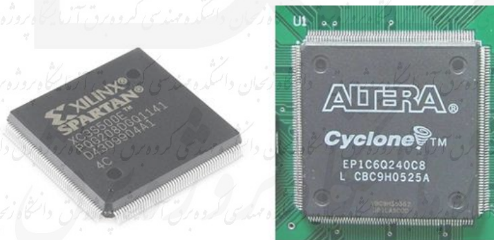
شکل ۱-۱: نمونه‌هایی از FPGA های شرکت‌های ALTERA و XILINX
